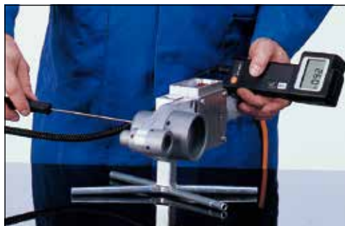
Temperaturkontroll med ytmätningssinstrument
