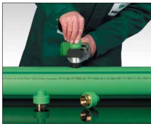
Uppvärmning av det element som skall svetsas
