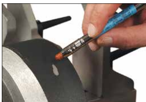
Temperaturkontroll med mätpenna
